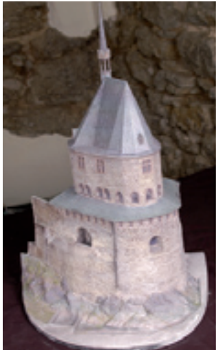
Burg Vianden, Kapelle. 3D-Modellbau mit photorealistischen Oberflächen. Mit RP-Technologien werden hochgenaue 3D-Modelle erzeugt. Durch das spezifische Aufbauverfahren können auch komplexe Hohlräume mit Hinter- und Unterschneidungen in sehr hoher Genauigkeit „gebaut“ werden. Durch die photorealistischen Oberflächen erreichen die Modelle einen hohen Realismus. Realisierung: ArcTron 3D (2008).
